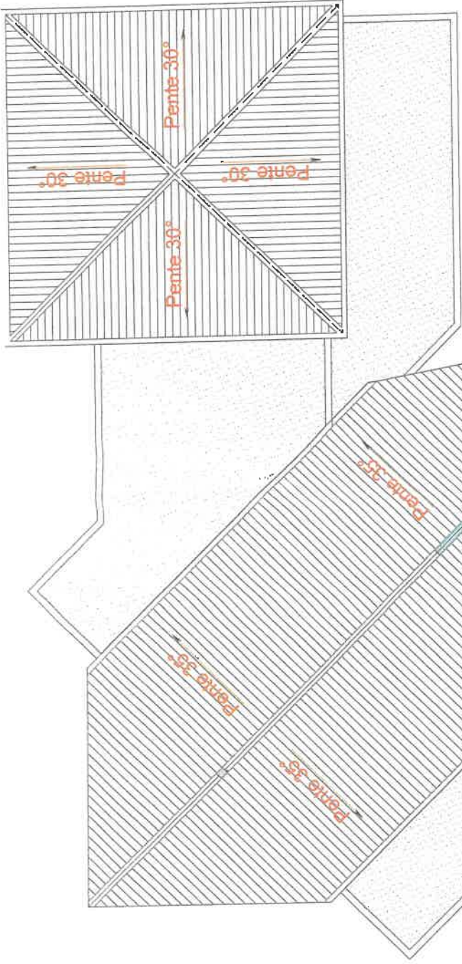
villa type 02 plan de toiture Ech: 1/100e
